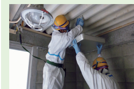
建材中の石綿試料の採取
